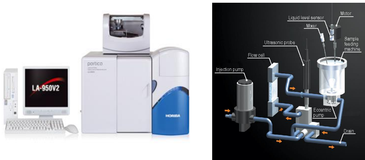
Figura 1. Aparatul - Horiba Partica LA-950V2 și mecanismul de funcționare (horiba.com)
