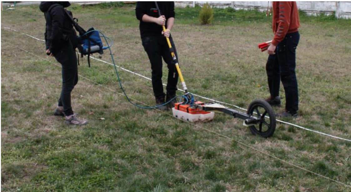
Figură 3. Exemplu de achiziție date georadar de-a lungul profilelor.
