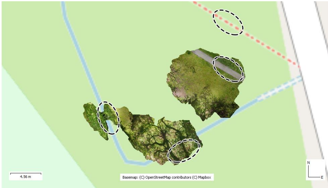
Figură 41. Ortomozaic în jurul movilei mai mici. Erori de poziționare sunt evidențiate.
