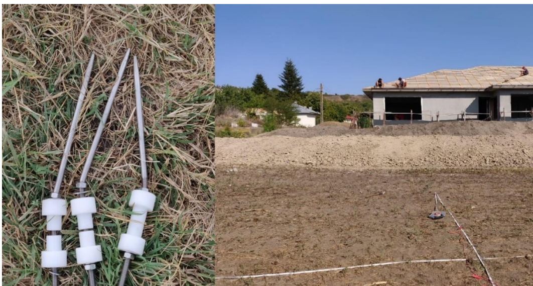
Figură 4. Electrozi ruși în urma măsurărilor într-o zonă cu sol foarte uscat.
