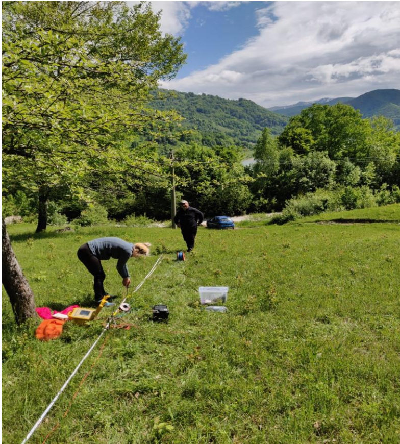
Figură 2 realizarea măsurătorilor de rezistivitate pe alunecarea de lângă lacul Poiana Ruscă
