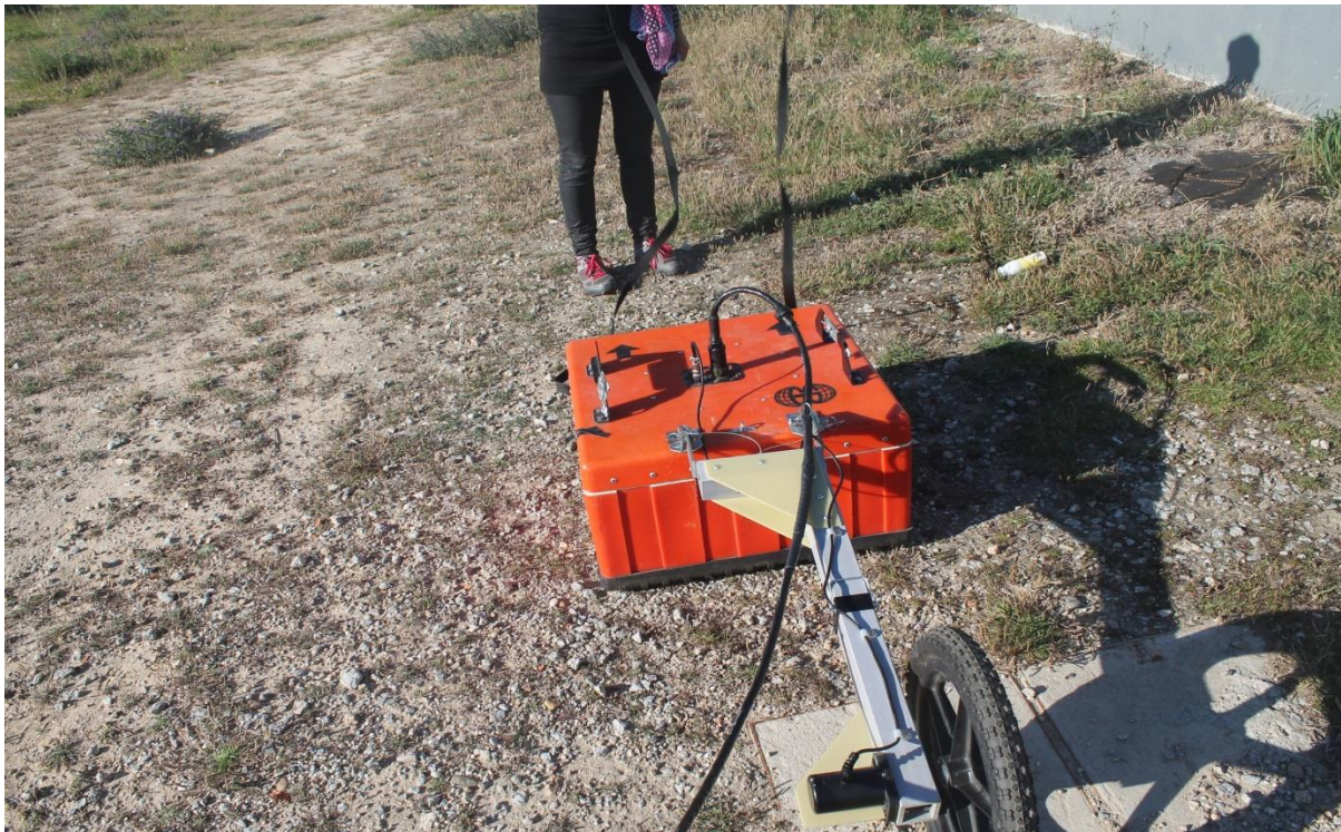
Figură 3 Realizarea măsurătorilor de georadar pe suprafața unui baraj, cu antena de 200MHz.
