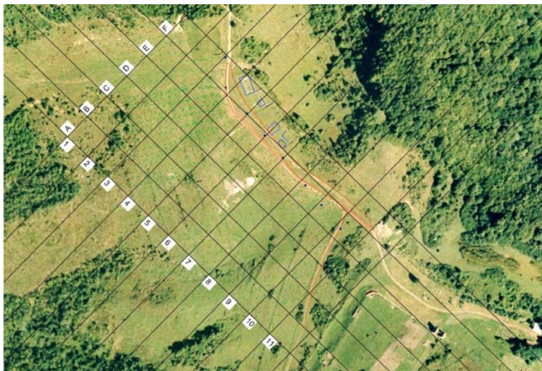
Figura 2 Trasarea gridului de măsură pentru măsurătorile geofizice de la Moigrad - Dealul Pometului jud. Sălaj, în imediata apropiere a castrului roman Porolissum. Celulele gridului au dimensiunea de 40 x 40 m. Ruinele castrului roman sunt vizibile în partea de Sud a imaginii aeriene.
