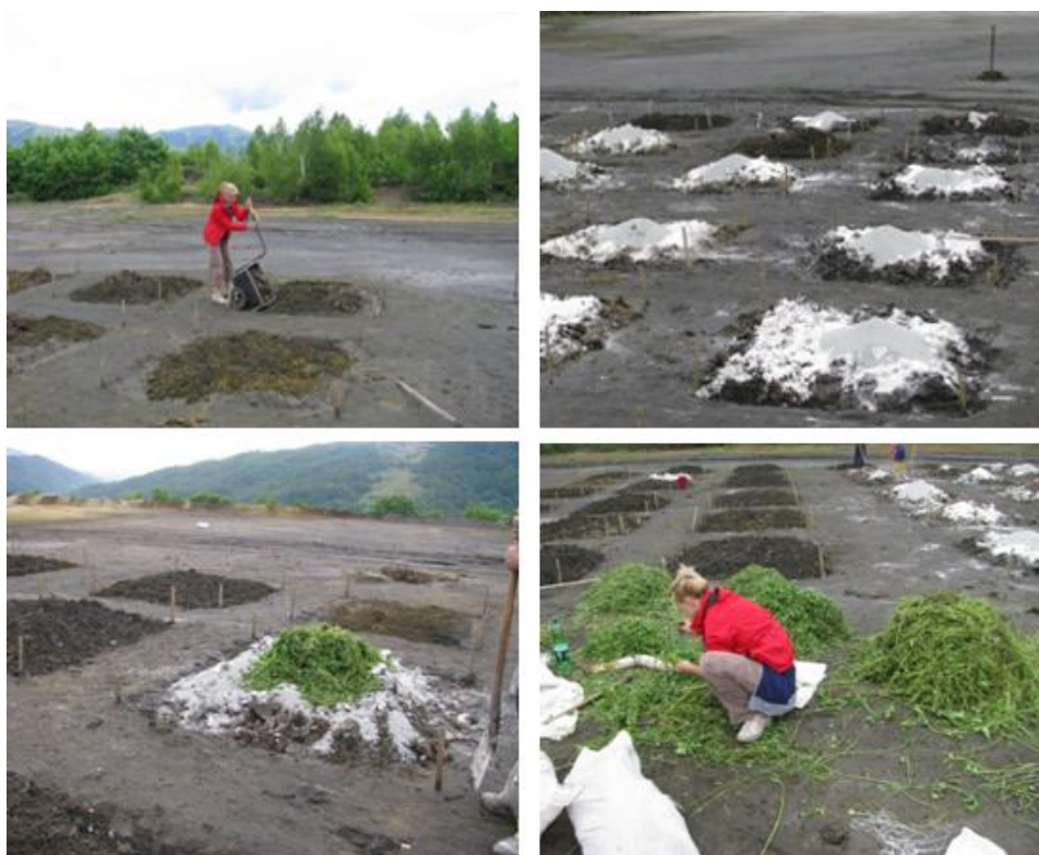
Fig.2.18. Aplicarea și omogenizarea amendamentelor pe fiecare parcelă experimentală
