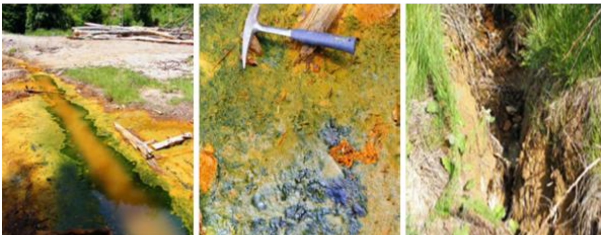
Fig.3.1.5 Drenare minieră acidă, precipitate secundare de fier și alge, împrejurimile minei Haneș (în imaginile din stânga și centru) (Grawunder, 2011), apele de exfiltrații, iazul de decantare Zlatna nr.3 (dreapta).
