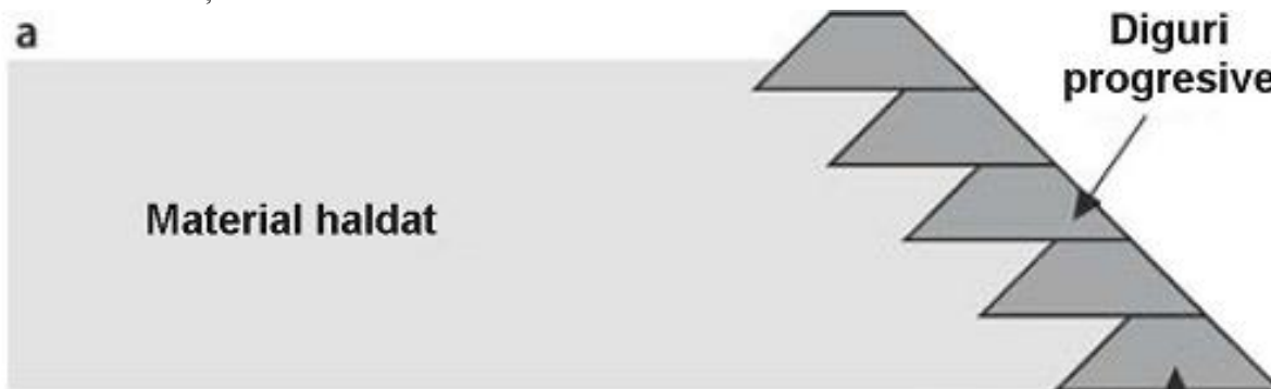
Fig.1.8. a Ilustrarea schematică (secțiune transversală) a construcției iazurilor de decantare. a. de vale (Iacob 2012, adaptat după Vick 1983)
