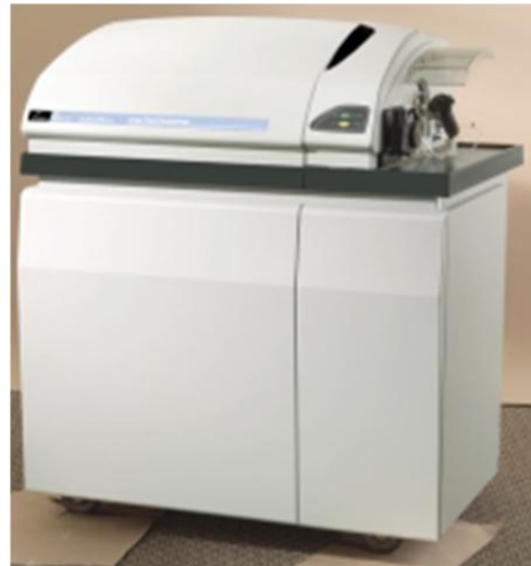
Fig.2.19 Cuptor de mineralizare Anton Paar Multiwave 3000 – Perkin Elmer (stânga) și spectrometru de masă cu plasmă cuplată inductiv ICP-MS Elan DRC-e, Perkin-Elmer (dreapta).
