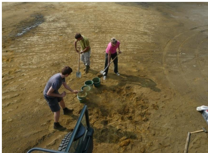
Fig. 2.13 Prelevarea substratului de pe iazul de decantare Zlatna nr. 3 Pârâul Sfârcii
