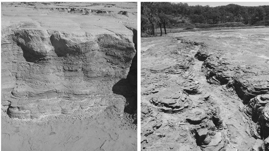
Fig.1.11. Imaginea din stânga prezintă eforescențele mineralelor albe (gips) prezente la bază, iar în partea dreaptă putem vedea eroziunea apelor de suprafață în multiplele straturi cimentate bogate în Fe ale iazului de decantare (Lottermoser și Ashley 2006).
