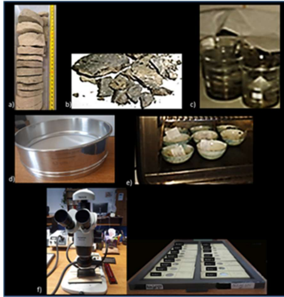
Fig. 2. Etape de lucru: (a) carotă (Blejești) din care se prelevează material, (b) material mărunțit, (c) pahare Berzelius cu material aflat la înmuiere, (d) sită cu dimensiunea ochiurilor de 63 µm (necesară pentru spălarea materialului), (e) recipiente de porțelan cu material pus la uscare în etuvă, (f) Microscop, camera foto și portcelulă (culegere, identificare specii, fotografiere și păstrare conținut mirofaunistic)
