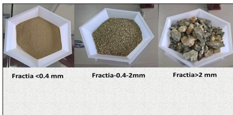
Figură 16. Imagine cu cele trei fracții granulometrice N1, N2, N3
