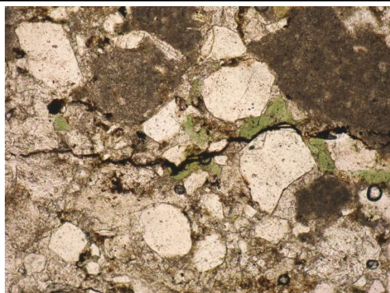
Fig. 6a Efecte ale compactării și dizolvării sub presiune: deformarea glauconitului detritic și stilolite (SS, 30x, NII)
