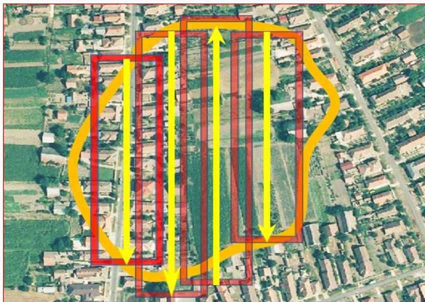
Fig.2.11 Zona de interes, liniile de zbor în direcția optimă (săgeți groase) și culoare cu suprapunere (dreptunghiuri)
