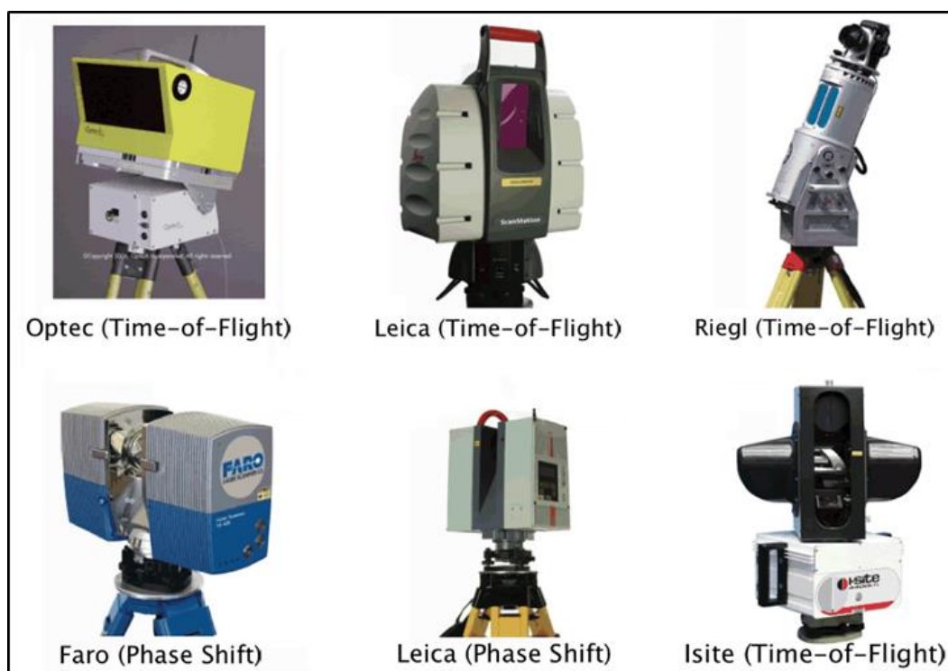
Fig.2.21 Modele de scanere laser bazate pe măsurarea cu laser continuu sau pulsatoriu
