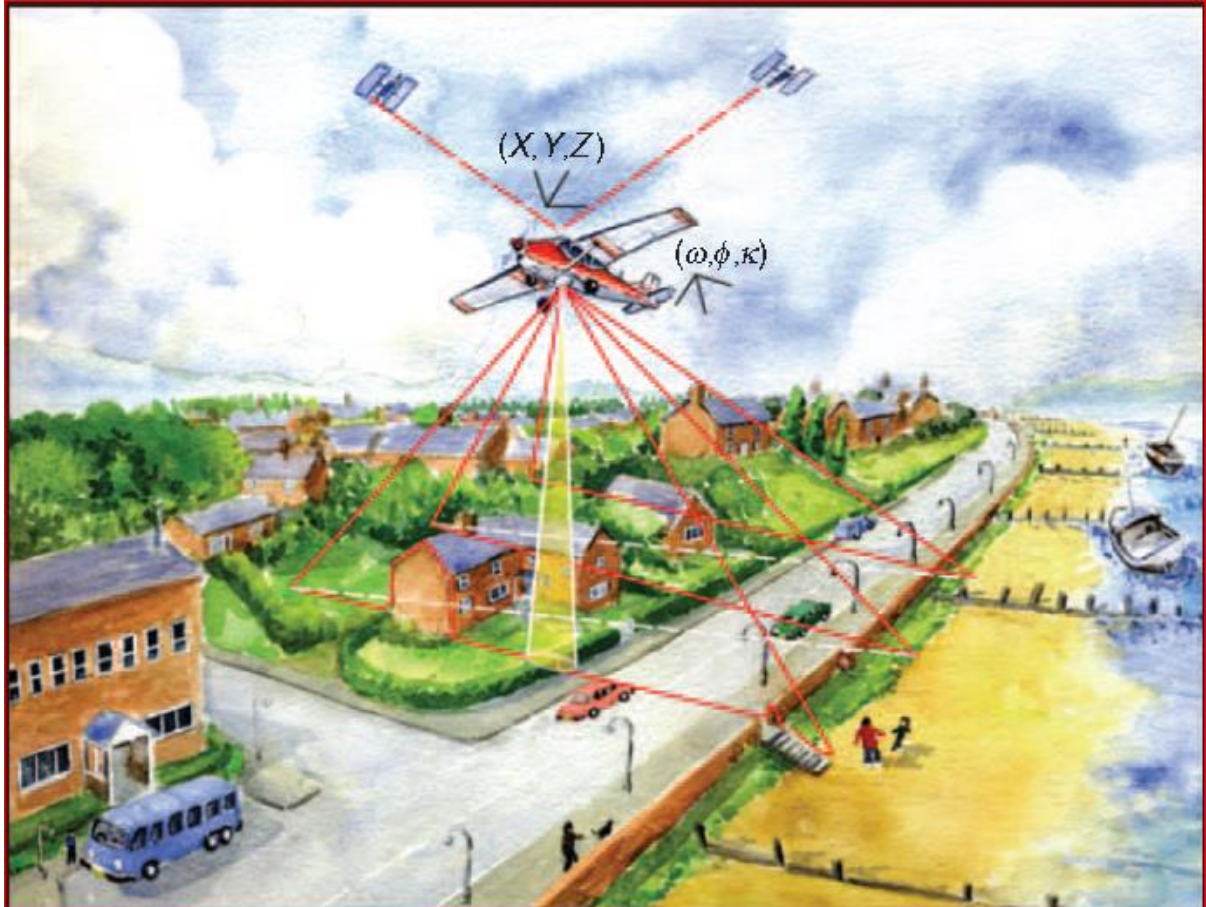
Fig.2.1 Principiile specifice tehnologiei LiDAR-ului aeropurtat [1]
