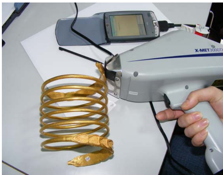
Figura 2. Spectrometrul poziționat pentru măsurarea obiectelor de dimensiuni mari
